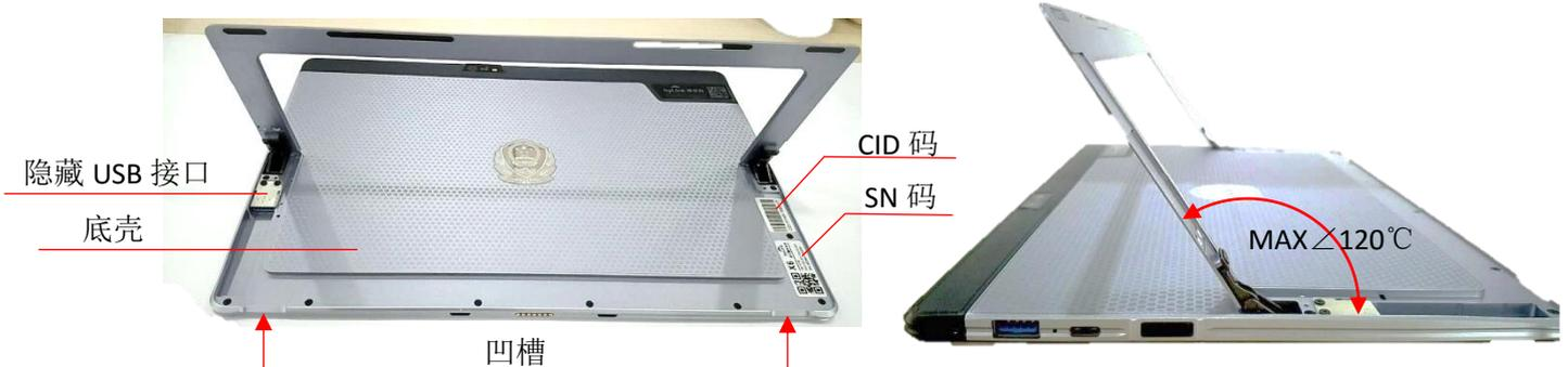
开转轴支撑架：将大拇指放于凹槽处，食指中指无名指按住底壳，大拇指用力往上提;
