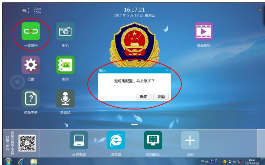
点击“确定”或单击警务桌面“设置”（该方法需密码进入，密码为当天年月日，例如 2017 年 3 月 14 日则输入 170314）进入配置窗口，“配置名称”必须填写（填写内容没有限制），**APN 填写内容必须跟当地公安搭建公安安全边**
